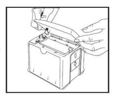
1. Push in to open top cover. Abra la cubierta superior.
