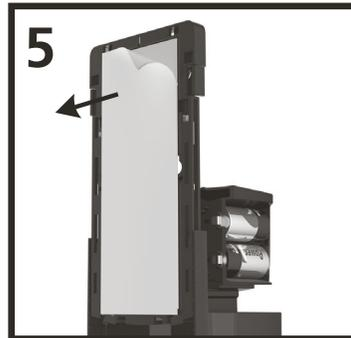
Nettoyez la surface d'installation avec une lingette d'alcool. Laissez sécher la surface pendant 60 secondes, puis pelez le papier du ruban et appuyez fermement à l'arrière du distributeur pendant 10 secondes. Pour une adhérence maximale, attendez 24 heures avant d'insérer une recharge ou d'utiliser le distributeur.
