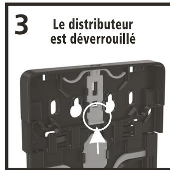
Rétablisiez la position verrouillée en poussant le mécanisme de verrouillage vers le haut du distributeur.
