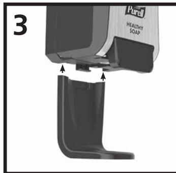
Installez le SHIELD™ Protecteur de mur et de plancher dans la base du distributeur en alignant les languettes de plastique du SHIELD avec les fentes du distributeur, puis en glissant vers le haut jusqu'à ce que les languettes s'enclenchent en place. (Le SHIELD est inclus avec les systèmes de désinfectants et peut être commandé pour les systèmes de savon.)
