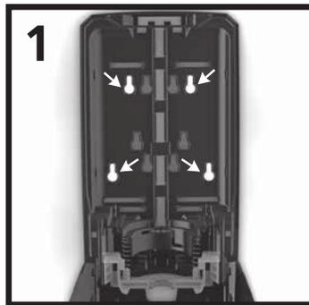
Utilisez la plaque arrière comme modèle, marquez et percez les trous du centre dans les murs en utilisant un foret à maçonnerie ou pour le bois de 6,3 mm (1/4 po).
